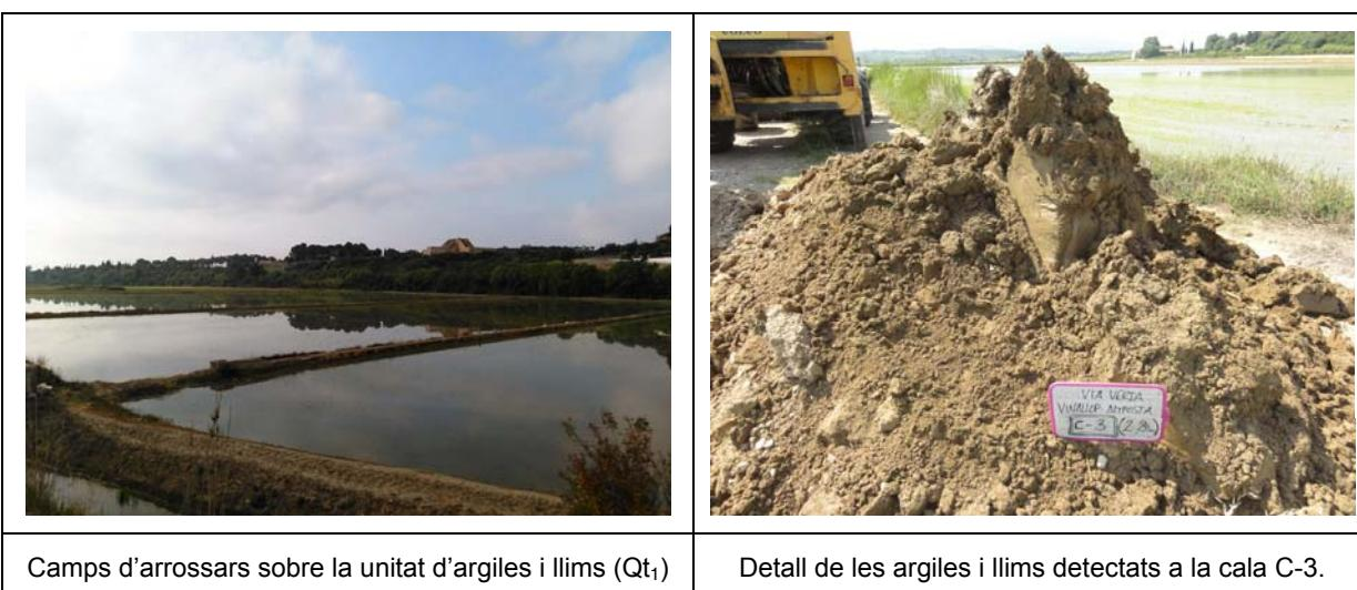
Sobre les mostres extretes de les cales C-3 (M-1) i C-4 (M-2) s'han realitzat assaigs de laboratori amb l'objectiu de determinar la classificació d'aquests sòls, segons l'article 330 del PG-3.
