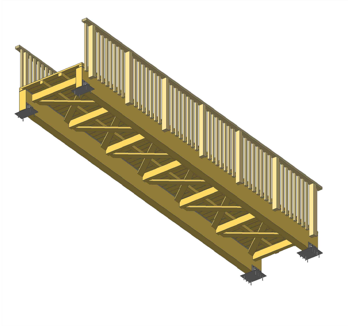
PASARELA PREFABRICADA VISTAS EN PERSPECTIVA
