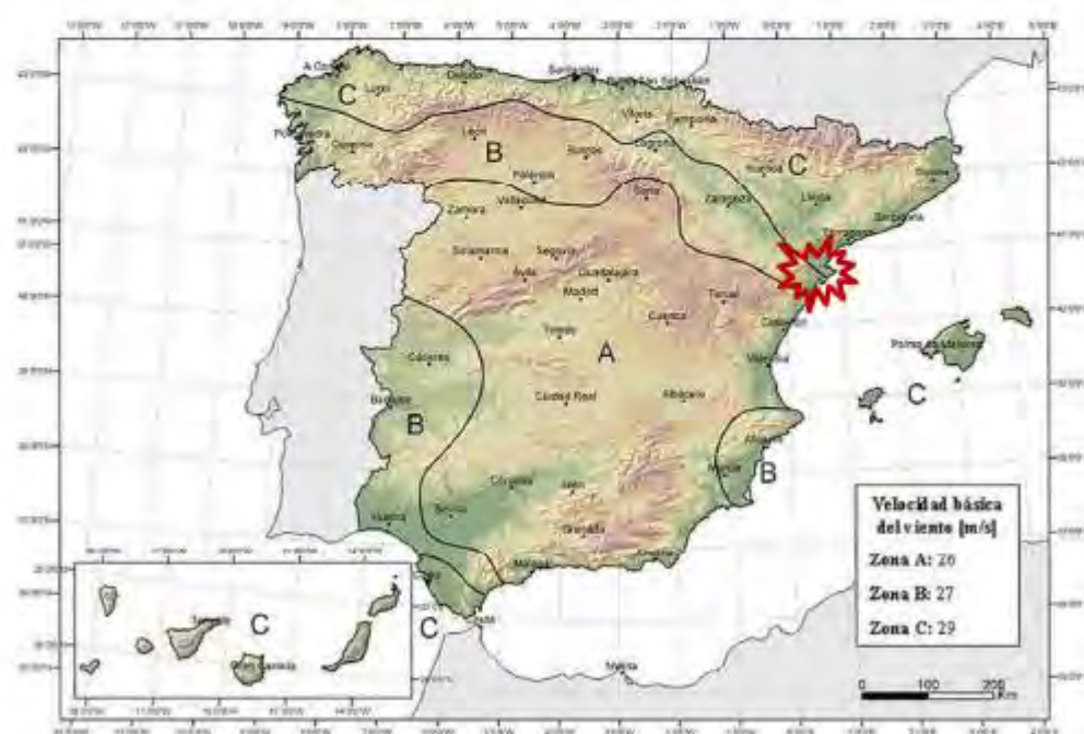
FIGURA 4.2-a MAPA DE ISOTACAS PARA LA OBTENCIÓN DE LA VELOCIDAD BÁSICA FUNDAMENTAL DEL VIENTO v_{0,0} (Coincide con el mapa correspondiente del Código Técnico de la Edificación)
